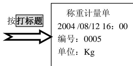
该键具有对称重数据进行统计打印的功能。如上例所示，在打印机打出标题后，在仪表上显示稳定的称量值时，按下 **打印** 后，打印机将打印出下面的行：
