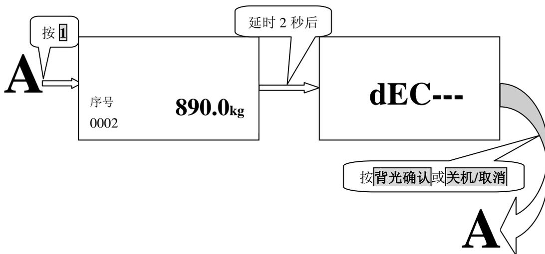
在上面的操作中，若无存储的称重数据，则显示“nod---”，此时必须按**关机/取消**键回到称重界面。
